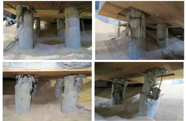
杭の損傷状況(杭頭の圧壊)
